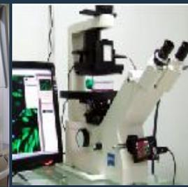
Лазерный флуоресцентный инвертированный микроскоп Carl Zeiss
