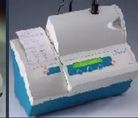
Люминометр счетчик Berthold Sirius
