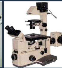
Флуоресцентный-DIC инвертированный микроскоп Olympus
